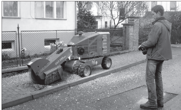
Frézování pařezů v Tržní ulici dálkově řízenou frézou
